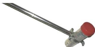
Tube de prélèvement (50 ml) fixé sur l'outil de prélèvement
